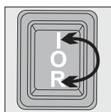
(2). Ajuste a "R" e "I" alternadamente hacia adelante y hacia atrás hasta que el papel atascado se afloje.
